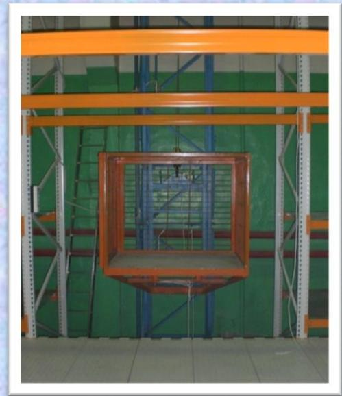
**В целях безопасности каждая платформа имеет ловитель, срабатывающий в случае обрыва каната электротельфера. Конечный выключатель, установленный на ловителе при этом размыкает цепь питания, отключая электродвигатель.**
