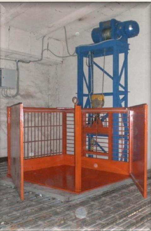
**Подъемник Ск-ПМ являются не стандартным оборудованием. Проектирование, изготовление и установка осуществляется по индивидуальному проекту, в зависимости от требований Заказчика.**
